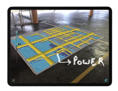
不到5分钟,即完成了包含21条扫描线(包括横向的12条线和纵向的9条线)的大面积区域扫描。用传统的单线扫描方法,即使是有经验的检测人员也可能需要15-30分钟才能完成。阵列式雷达GP8100的每次扫描实际上是6条线同时进行,这不仅减少了扫描时间,而且使用户能够获得钢筋和导管布局的即时图像(在"超级线扫"视图内),而不需要通过传统雷达波视图分析。导管如此明显,即使是经验不足的用户也能找到这个隐蔽的目标。
