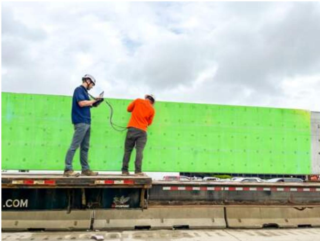
作为控制测试区域，Durability Engineers 在 12 英尺 x 2 英尺直接传输网络上执行了 UPV，穿过光束的宽度（1.5 英尺）。速度读数范围从 14,865 英尺/秒到 16,145 英尺/秒，平均速度为 15,730 英尺/秒。进行这种直接 UPV 测试以确定混凝土的基线速度并校准间接 UPV 测试的测量值。
