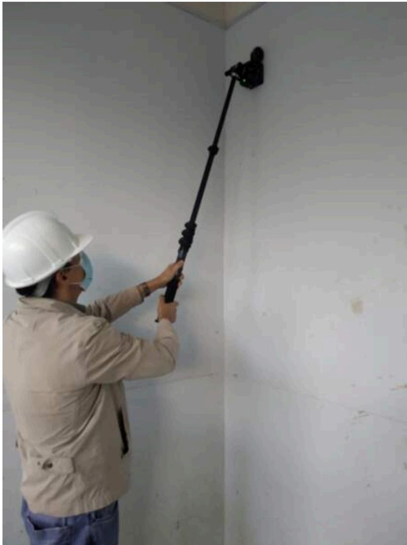
该研究的目的是调查掩体其余部分的构造和结构特征，表征建造它的混凝土以确定其当前状态。研究人员使用 Proceq GP8800 确定钢筋布局并检查是否存在任何“双壁”。他们发现钢筋状况良好，一些墙壁确实看起来有两层——传统混凝土和重晶石混凝土。他们推断这是因为检测到两层钢筋相距约 40 厘米；然而，这只能通过破坏性测试来确认，而破坏性测试是不允许在这些墙上进行的。他们得出结论，探地雷达可以在不对墙壁进行破坏性测试的情况下确认辐射防护的加强。
