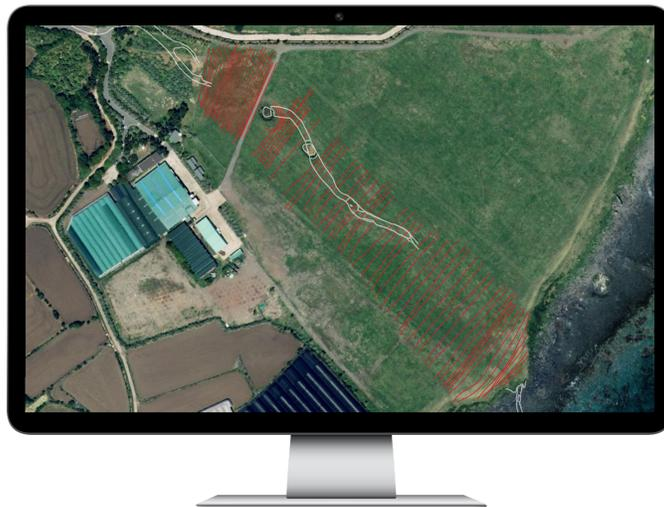
Для более глубокого анализа команда использовала программное обеспечение для постобработки [GPR Slice](#). На этом изображении видны белые линии, которые представляют собой распределение подземной лавовой пещеры с помощью 3D-сканирования.
