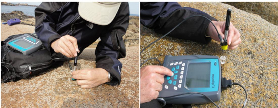
O leve impacto do martelo de ricochete Schmidt não danificou as superfícies de betão ou rocha, tornando-o adequado para locais frágeis, enquanto o [Equotip](#) forneceu medições altamente precisas para dados de correlação de dureza.
