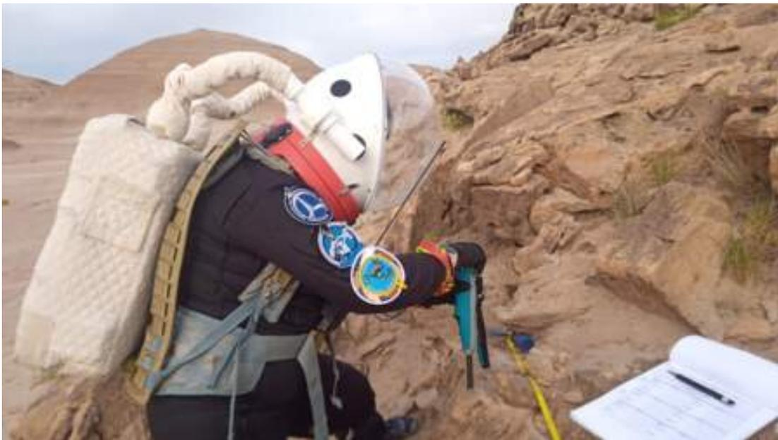
O [aparelho de teste de dureza Equotip](#) é utilizado principalmente para avaliar metais, mas também é uma ferramenta conveniente para testar a resistência à compressão não confinada (UCS) de rochas.
