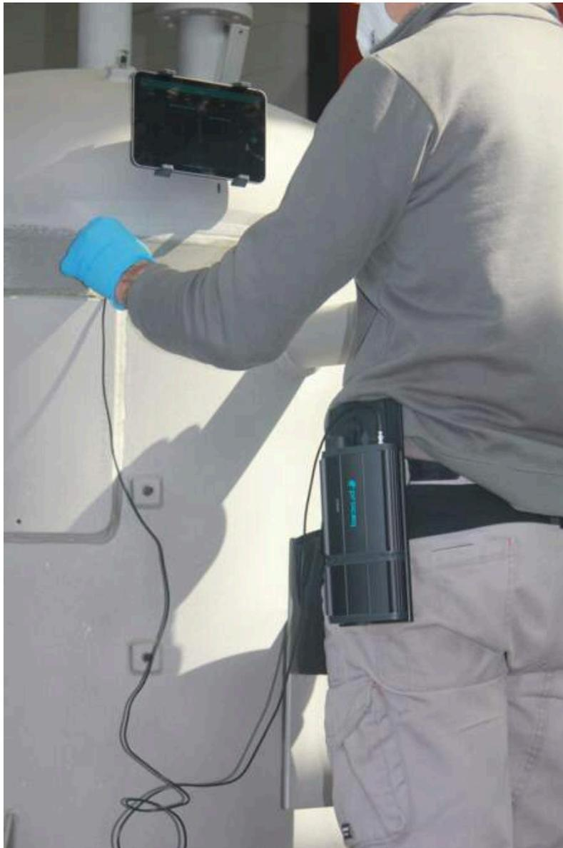
Con entrambe le mani libere, è ora possibile completare l'ispezione con la massima flessibilità possibile, utilizzando la sonda e altri strumenti (gel, misuratore) con facilità.
