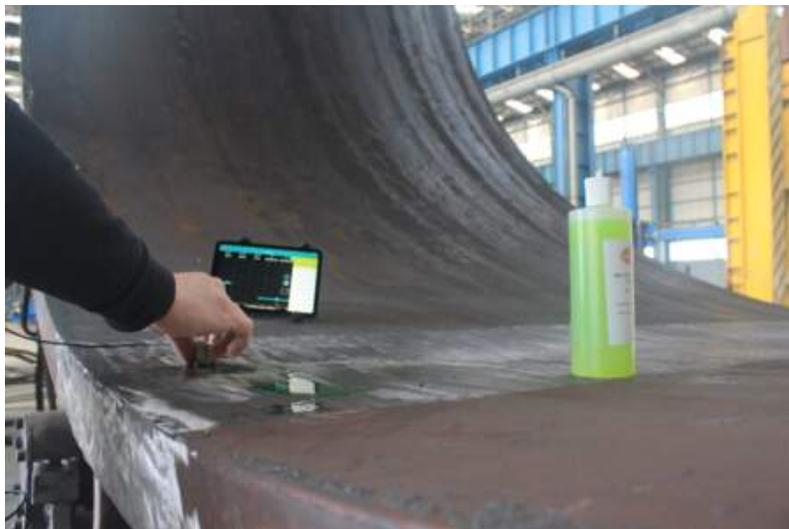
Grazie alle funzioni di connettività e tracciabilità [dell'UT8000](#), l'ispezione verrà inviata immediatamente a [Workspace](#) e i dati saranno accessibili ovunque tramite browser. La posizione, l'ora dell'ispezione, l'impostazione dei parametri, i dati eco grezzi, le foto e molto altro ancora saranno disponibili e registrati automaticamente. Tutte queste informazioni rimarranno accessibili e il consumatore finale avrà una verifica tangibile della qualità del controllo.
