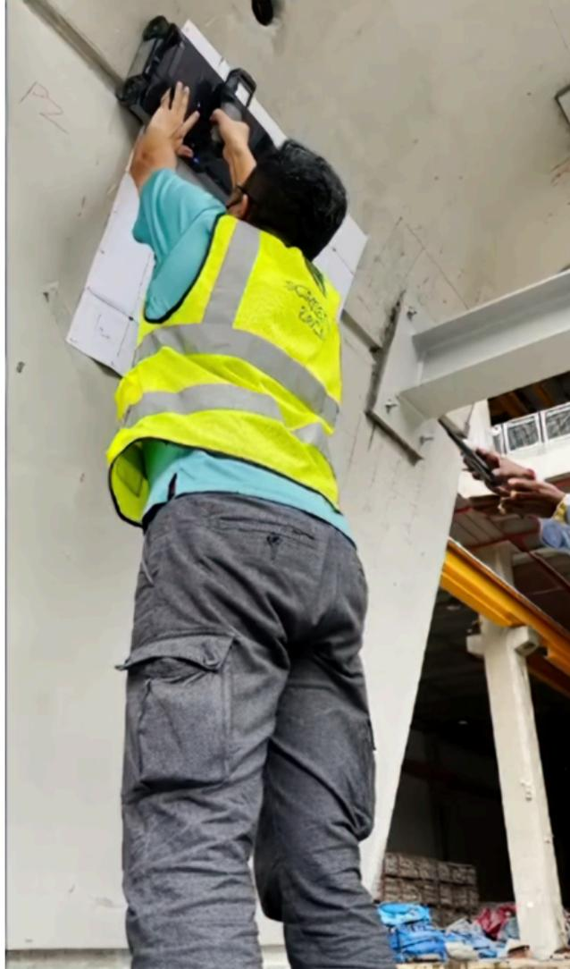
Grazie all'utilizzo di un potente software di raccolta dati, il [GP8100](#) visualizza i dati 3D in tempo reale e i risultati possono essere presentati in diverse viste, come time-slice o come visualizzazione in Realtà Aumentata (AR) dell'area scansionata. L'incorporazione dei risultati 2D o 3D sul sito utilizzando l'AR, ci permette di catturare la realtà del sottosuolo così com'è e di creare un report intuitivo.
