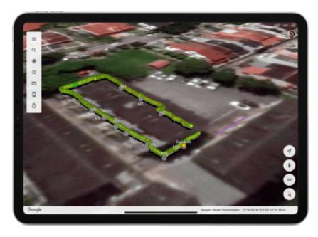
È stata eseguita una scansione dell'area di 7 m per 3,5 m con una distanza di 0,25 m e il tubo è stato localizzato. Il team è stato in grado di vedere il tubo, la sua direzione e profondità e di visualizzarlo in realtà aumentata, consentendo di capire la sua esatta posizione.
