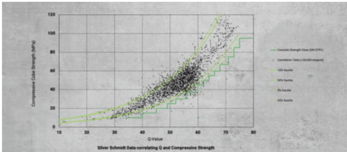
Come per ottenere i risultati delle prove di schiacciamento, anche il metodo del rimbalzo è statistico. Se usato correttamente, consente di ottenere una stima della resistenza del calcestruzzo più affidabile, olistica e molto più conveniente se combinato con alcune prove di schiacciamento.
