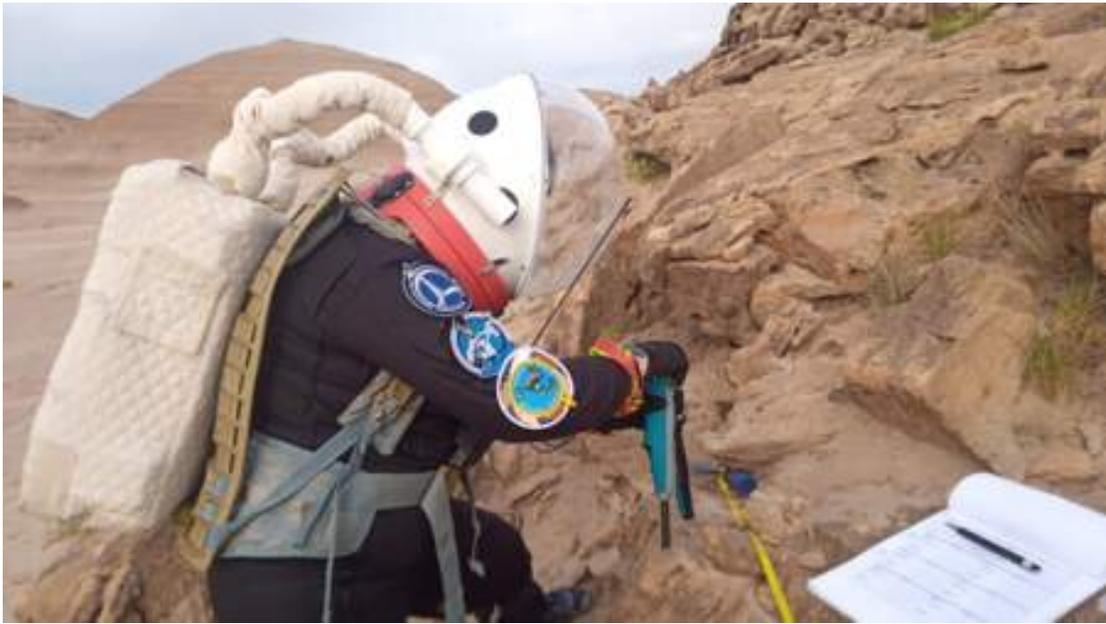
Il [durometro Equotip](#) è utilizzato principalmente per valutare i metalli, ma è anche uno strumento conveniente per testare la resistenza alla compressione non confinata (UCS) delle rocce.
