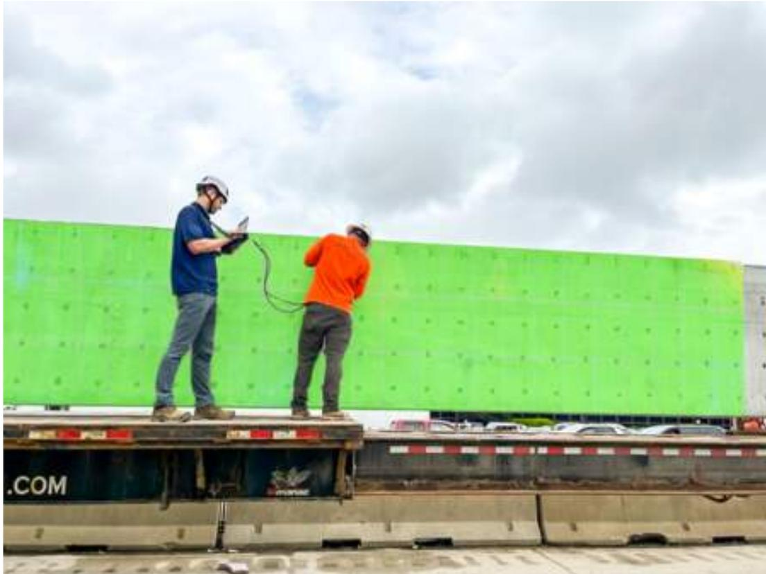
Come area di prova di controllo, Durability Engineers ha eseguito un test UPV su una griglia di trasmissione diretta di 12 piedi per 2 piedi attraverso la larghezza della trave (1,5 piedi). Le letture della velocità variavano da 14.865 ft/s a 16.145 ft/s, con una media di 15.730 ft/s. Questo test UPV diretto è stato eseguito per determinare la velocità di base del calcestruzzo e per calibrare le misure per i test UPV indiretti.
