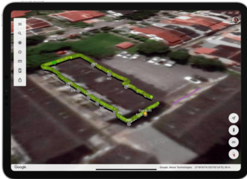
Un balayage d'une zone de 7 m sur 3,5 m avec un espacement de 0,25 m a été effectué et la conduite a été localisée. L'équipe a pu voir la conduite, sa direction et sa profondeur et la visualiser en réalité augmentée, ce qui lui a permis de comprendre son emplacement exact.
