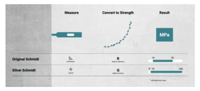
Oui, il y en a - et c'est là qu'interviennent les marteaux à rebond Schmidt pour l'estimation de la résistance et de l'uniformité du béton. Nous avons inventé le principe de Schmidt il y a plus de 60 ans et la méthode est totalement non destructive.
