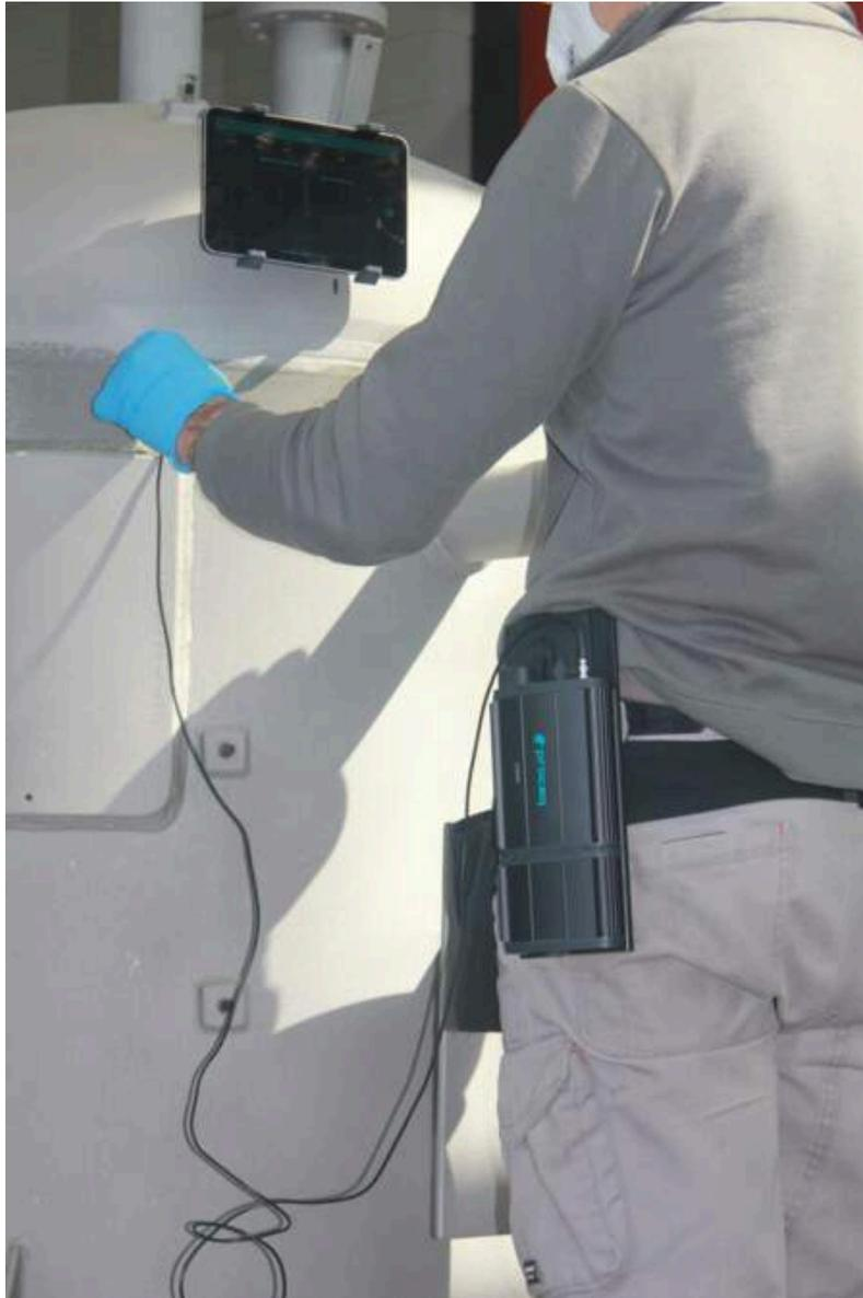
Con las dos manos libres, ahora es posible completar la inspección con la mayor flexibilidad posible, utilizando la sonda y otras herramientas (gel, medidor) con facilidad.
