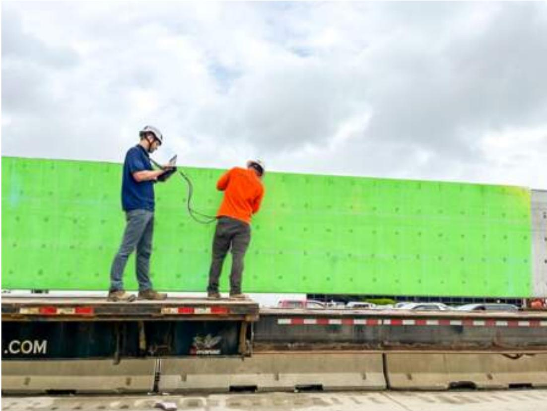
Como área de prueba de control, Durability Engineers' realizó UPV en una rejilla de transmisión directa de 12 pies por 2 pies a través del ancho de la viga (1,5 pies). Las lecturas de velocidad oscilaron entre 14.865 pies/s y 16.145 pies/s con una media de 15.730 pies/s. Este ensayo UPV directo se realizó para determinar la velocidad de referencia del hormigón y calibrar las mediciones para el ensayo UPV indirecto.
