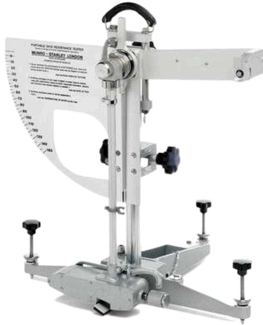
Resistencia al deslizamiento de las marcas de carreteras
