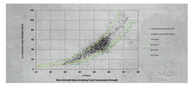
Wie bei der Ermittlung der Ergebnisse von Druckversuchen ist auch die Rückprallmethode eine statistische Methode. Bei richtiger Anwendung liefert sie in Kombination mit einigen wenigen Druckversuchen eine zuverlässigere, ganzheitlichere und wesentlich kostengünstigere Schätzung der Betonfestigkeit.
