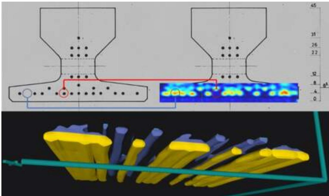
Der blaue Kreis zeigt eine Stelle, an der keine vorgespannten Bewehrungslitzen vermutet wurden, tatsächlich aber vorhanden waren, und der rote Kreis zeigt eine Stelle, an der das Gegenteil der Fall war. Die GPR-Inspektion verhinderte also, dass Strukturelemente beschädigt wurden, als die Bohrkerne zur Laboruntersuchung entnommen wurden.
